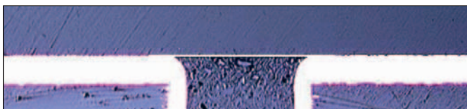
Querschnitt einer Bohrung von 0,50 mm. Vergrößerung 100 : 1.
