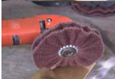
Für den mobilen Einsatz sind Winkelpolierer hervorragend geeignet. Hiermit können Werkzeuge bis 200 mm Durchmesser eingesetzt werden.
