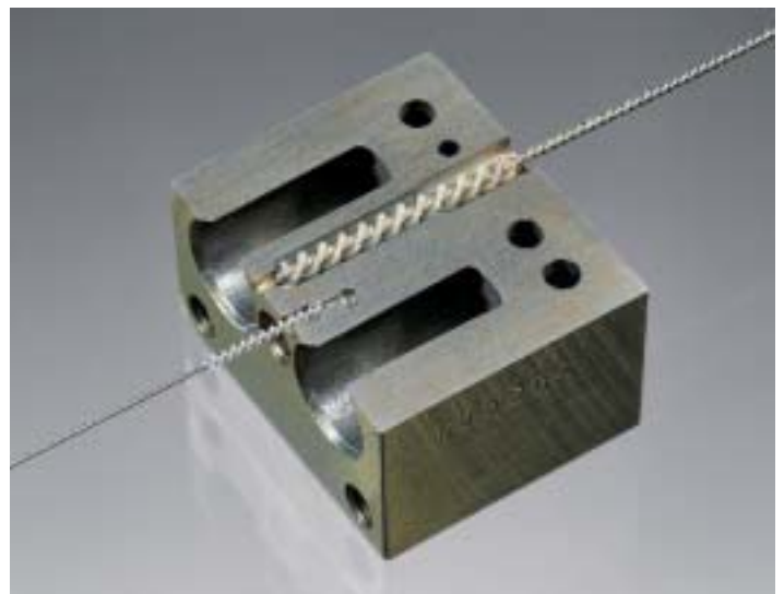
Steuergehäuse, Entgraten von Querbohrungen Steering housing, Deburring the cross holes
